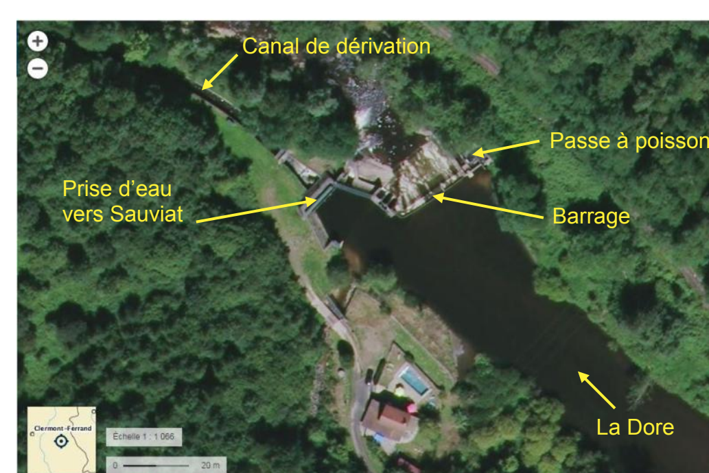
Vue aérienne du lieu-dit Les Prades. Barrage sur la Dore pour la prise d'eau vers le réservoir de Sauviat. - Capture d'écran IGN Géoportail
